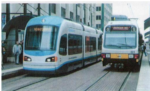
写真: 架線がない車両(左側)
