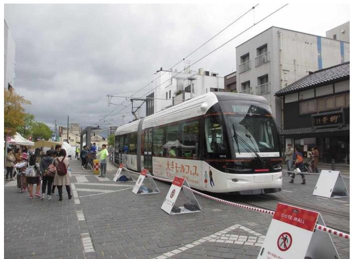
写真1：トランジットモールを走行するセントラムの大手フェス PR ラッピング車、線路と歩行エリアの間は柵で仕切られ、横断箇所が設けられている
