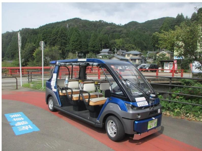
写真4：車両 路面の電磁誘導線を検知して無人走行
