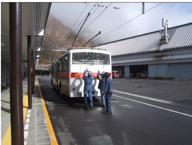
本線上でのポール上げ作業
